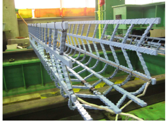
(b) グリッドメタルの曲げ加工
